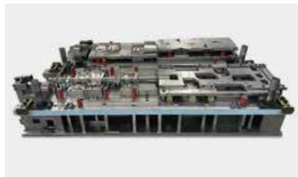
300t 順送型 材質：SCGA270D-45 板厚：1.0mm
