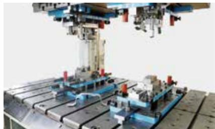
単発型(BK+5工程) 材質：SCGA270D-45 板厚：1.0mm
